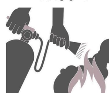
Descargue el agente extintor de un lado a otro en movimiento de barrido.
